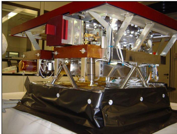
PFS: (Espectrómetro Planetario Fourier) sondeo vertical de la atmosfera por espectroscopia infrarroja de Fourier
